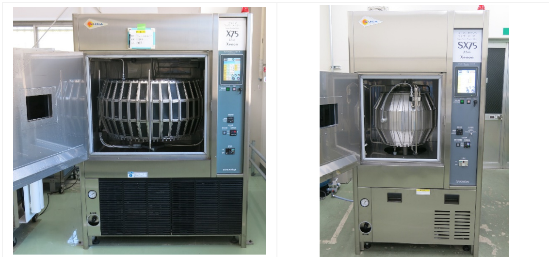
図 2.1 キセノン促進耐候性試験機 X75（左）と SX75（右）の外観
