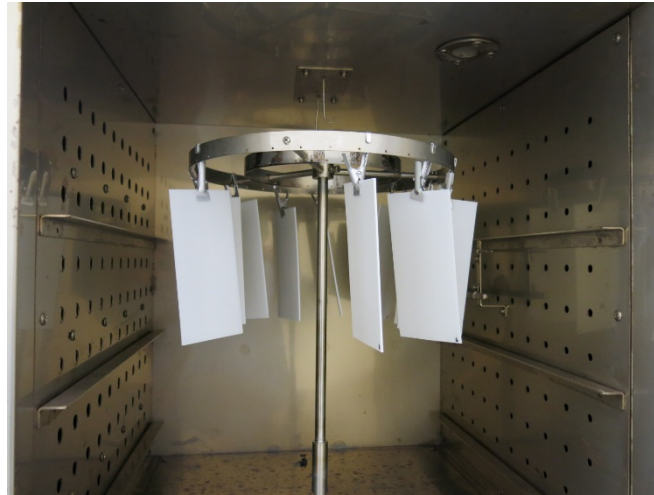
図 2.2 試験時のギヤオープン内部の様子
