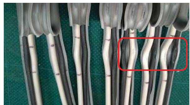
サンプル#1試験後(絶縁体) (赤枠の3点は絶縁体割れあり)
