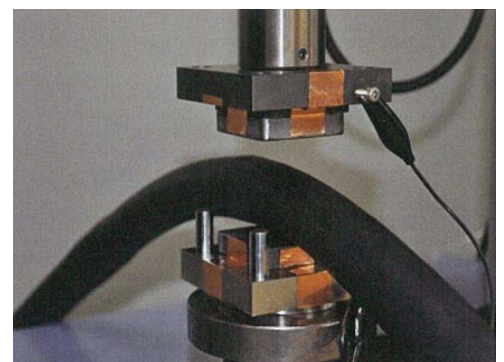
圧縮試験写真 (写真は別種のケーブル)
