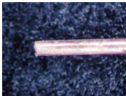
図 3.4 フラットな破断面の様子 (荷重 100g)
