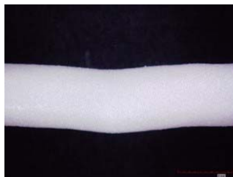
PVC (18年度再試作品)(23℃ 試験後破断部)
