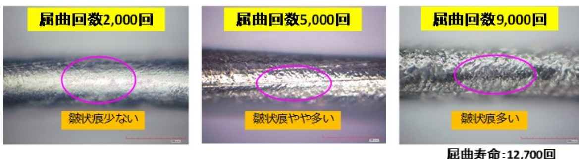
図 4.6 PVC の屈曲途中の導体観察（PVC、温度 23℃、設定曲げひずみ量 0.15）
