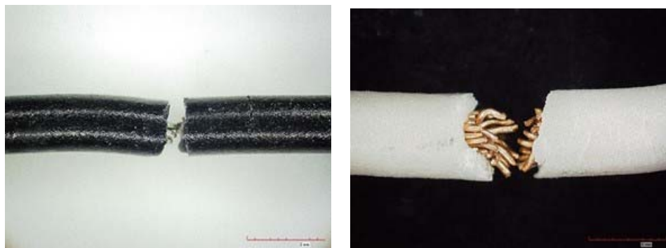
PVC (20年度品)(-15 試験後破断部) PVC (18年度再試作品)(-15 試験後破断部)
