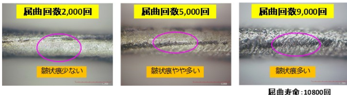
図 4.7 XLPE の屈曲途中の導体観察（温度 23℃、設定曲げひずみ量 0.15）
