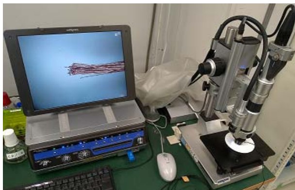
図 3.13 デジタルマイクロスコープ装置写真
