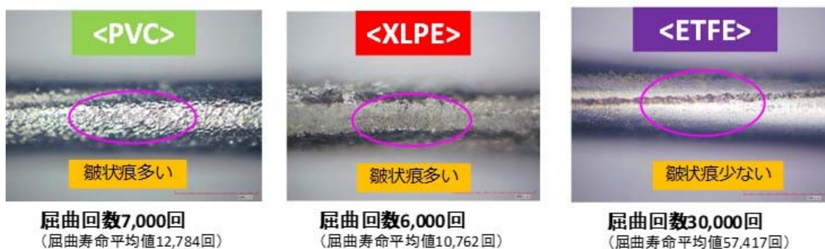
図 4.9 屈曲寿命 5 割の屈曲途中の導体観察 (温度 23℃、設定曲げひずみ量 0.15)
