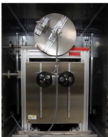
図1 恒温槽付屈曲試験機
