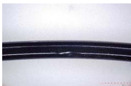
図 4.27 ETFE (-15 試験後破断部) 試験後の破壊部の観察
