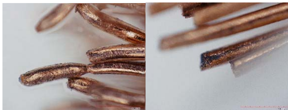
破壊部（試験温度-15℃）
