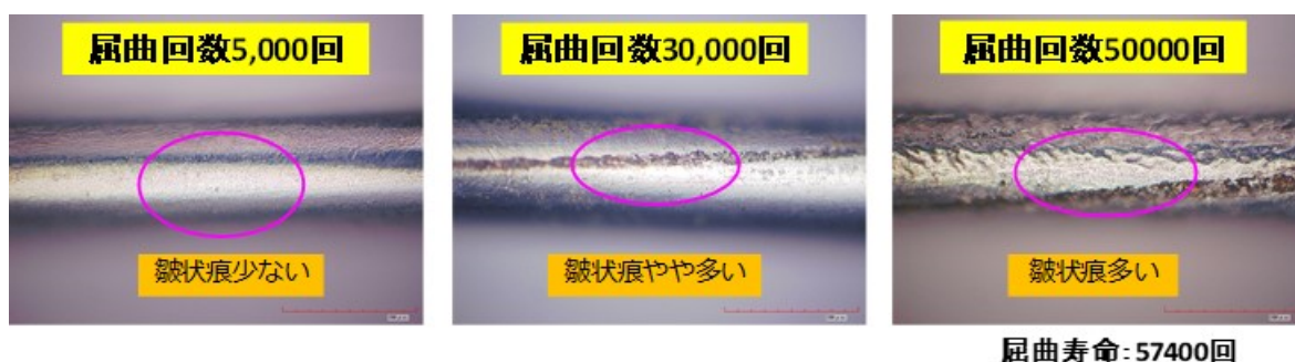
図 4.8 ETFE の屈曲途中の導体観察 (温度 23℃、設定曲げひずみ量 0.15)
