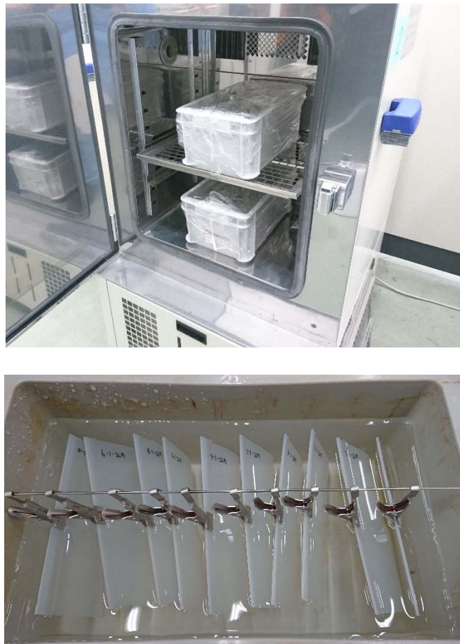
図 2.3 温水浸漬試験時の恒温槽内（上）及び容器内の（下）様子
