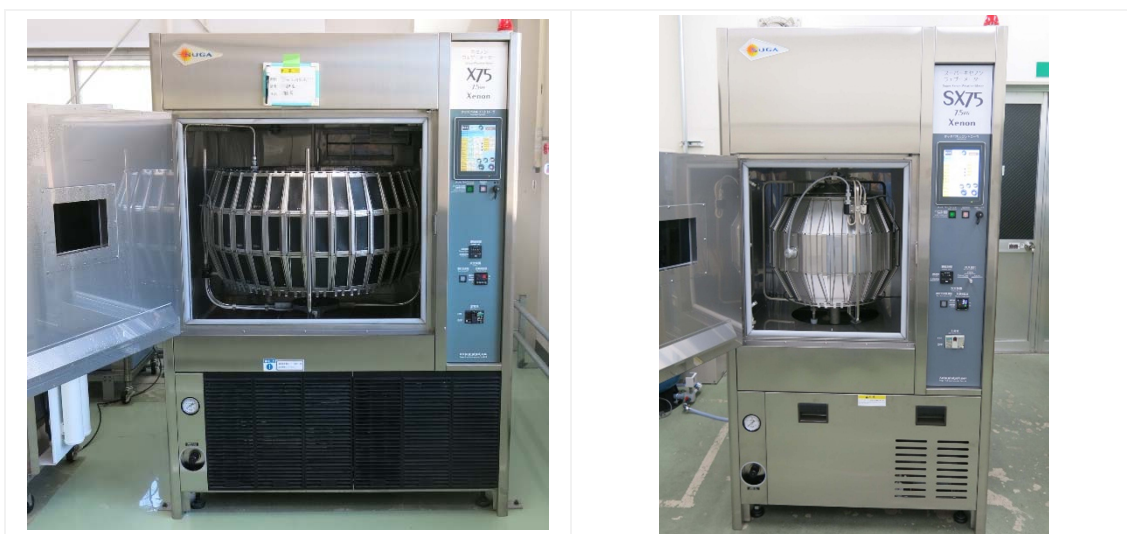
図 2.1 キセノン促進耐候性試験機 X75（左）と スーパーキセノン促進耐候性試験機 SX75（右）の外観
