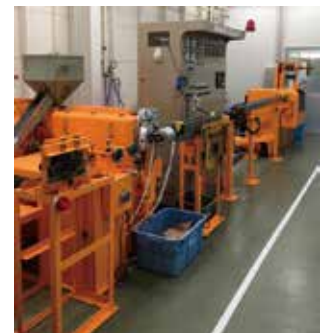
JECTEC環境棟 40mm押出機 (電線試作と評価を実施)
