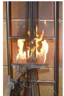
垂直トレイ IEC燃焼炉(多条ケーブル垂直トレイ燃焼試験)
