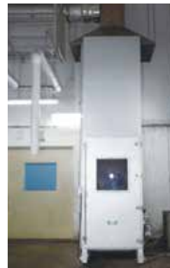
垂直トレイ IEC燃焼炉(多条ケーブル垂直トレイ燃焼試験)
