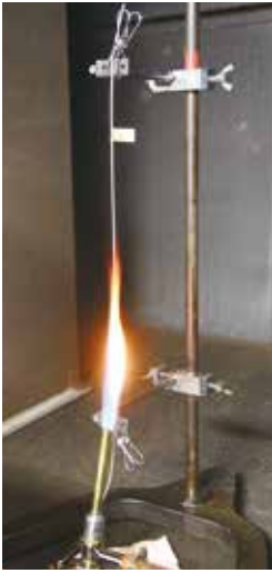
一条ケーブル燃焼試験
