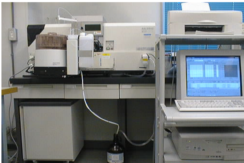
図2.(2)-2.原子吸光分析装置の設置状況
