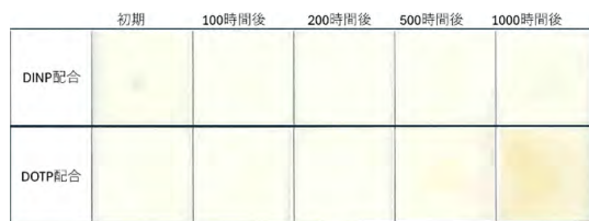
図8 サンシャインウェザーメータによる耐候試験後の色相変化
