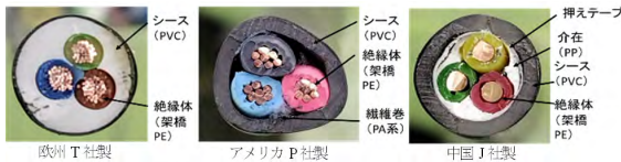
写真1 入手したケーブルの断面構造
