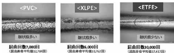
図3. 屈曲途中の導体表面光学顕微鏡写真
