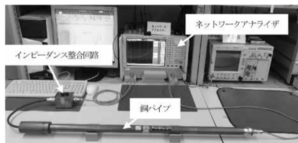
図3. トリアクシャル法測定構成写真
