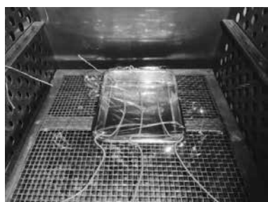
図6 耐バッテリー液性試験の様子 (ギヤードオープン中で行う)
