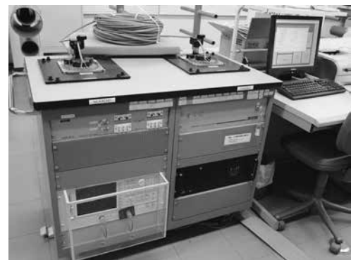
写真2 通信ケーブル特性自動測定装置
