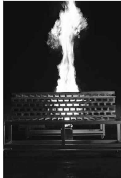
火災模型燃焼の様子(燃料体は1.8mの杉乾燥材)
