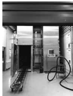
垂直トレイ燃焼試験装置
