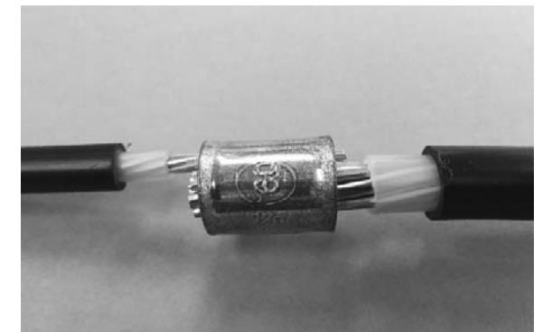
写真1 引張強さを評価するモデルサンプル
