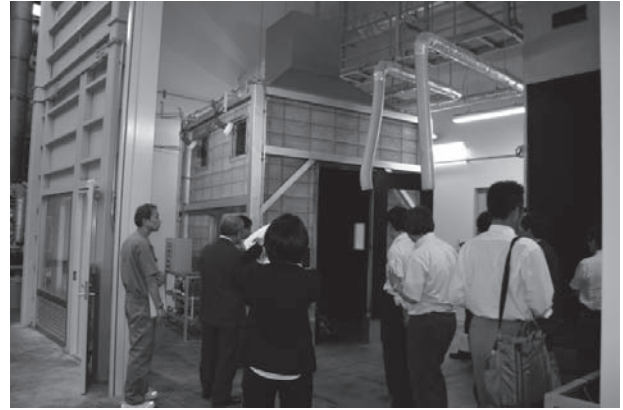
写真2 垂直トレイ燃焼試験装置
