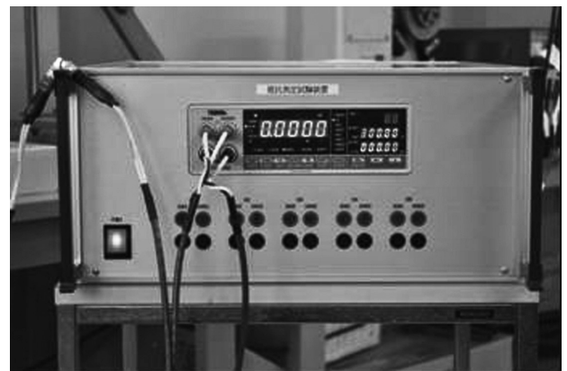
写真1 導体抵抗測定装置
