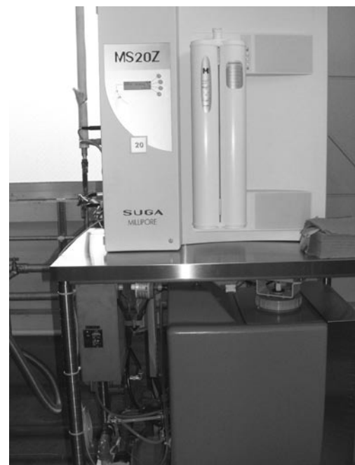
写真 3 自動純水装置
