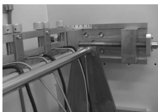
写真4 5連式ケーブル耐屈曲試験機 屈曲箇所
