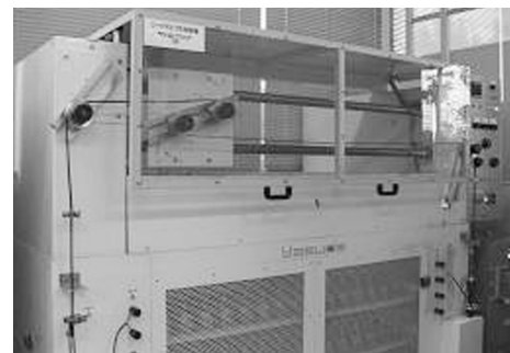
写真6 コードの移動曲げ試験装置
