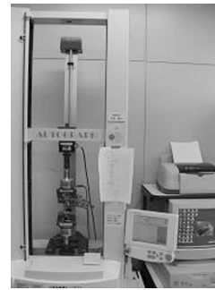
写真4 引張試験装置
