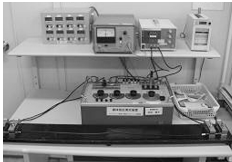
写真2 導体抵抗測定装置
