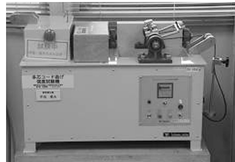
写真5 コードの曲げ強度試験
