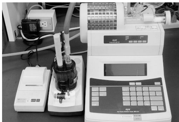
水分量測定設備(カールフィッシャー水分計)
