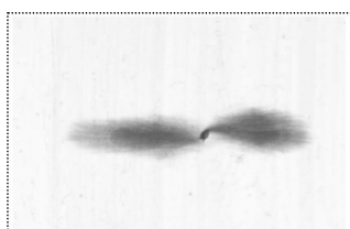
CV ケーブル中のボウタイ状水トリー例
