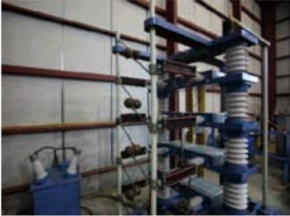
400kV衝撃耐電圧試験
