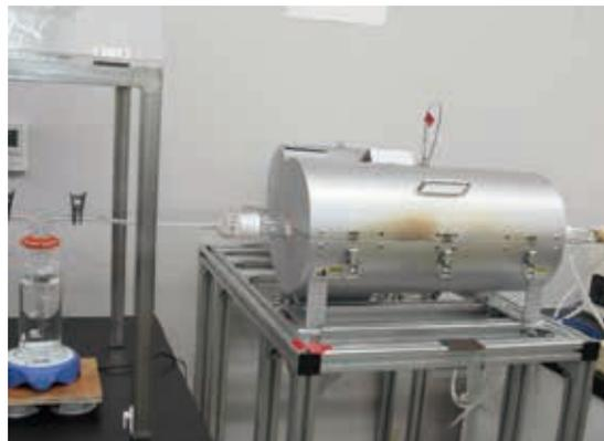
燃焼時発生ガス試験
