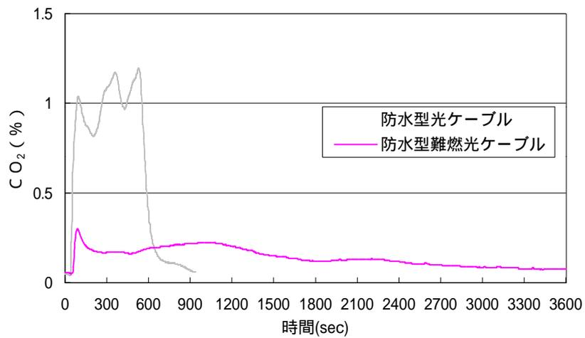
図2.(3)-11 防水型光ケーブルと防水型難燃光ケーブルのCO<sub>2</sub>発生量
