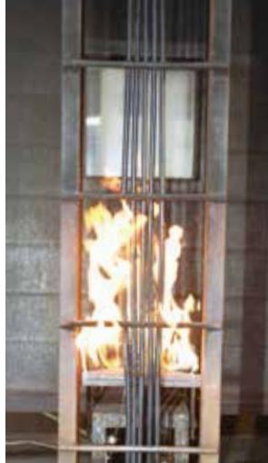
多条ケーブル垂直トレイ燃焼試験
