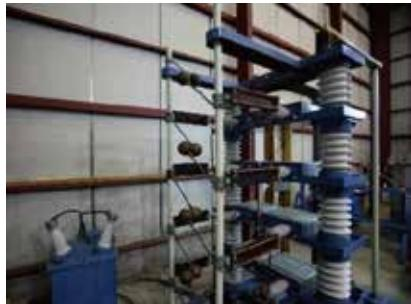
400kV衝撃耐電圧試験
