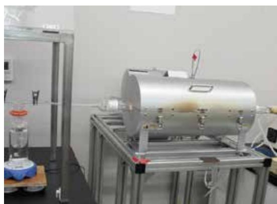
燃焼時発生ガス試験
