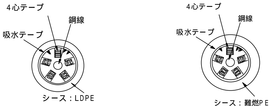
図 3.(3)-5 100 心 SM 防水型光ファイバケーブル 図 3.(3)-6 100 心 SM 防水型難燃光ファイバケーブル
