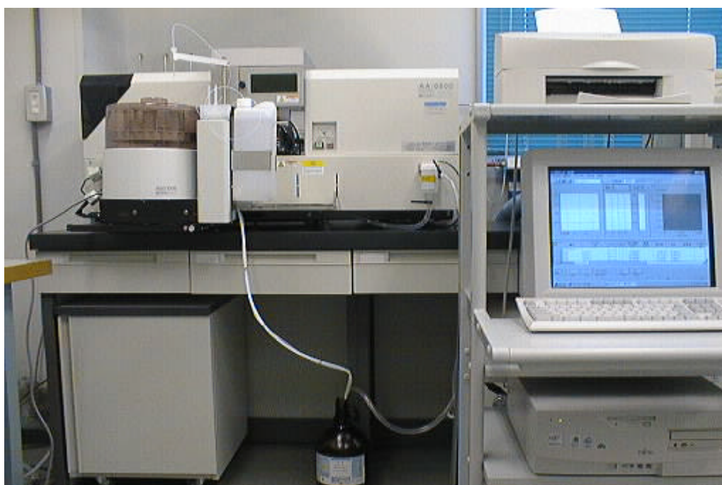
図2.(2)-2.原子吸光分析装置の設置状況
